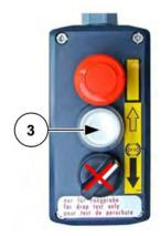
Abb. 100: Bedienung Fangprobensteuerung
