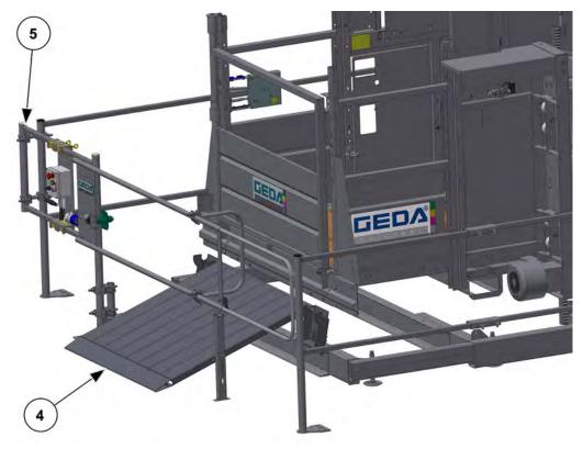
Abb. 50: Auffahrrampe am Bühnenzugang Bodenstation
