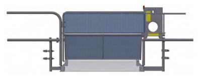
Abb. 68: Etagensicherungstür "Comfort" geschlossen (Lochblech)
