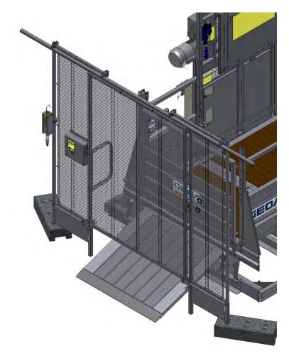
Abb. 39: Schiebetür für Bodenumwehrung geschlossen
