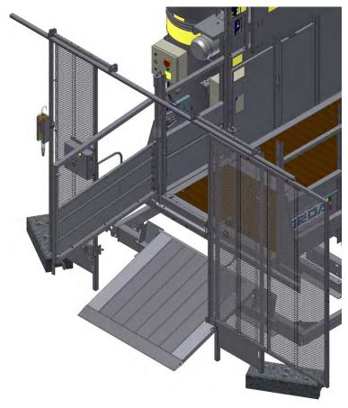
Abb. 43: Schiebetür für Bodenumwehrung geöffnet
