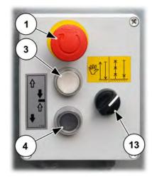
Abb. 79: Bodensteuerung für Umwehrung (AUTOMATIK)
